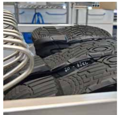
... und bei billiger Verarbeitung und schlechter Qualität sieht der Schuh dann so aus. In diesem Falle war die Sohle nur am Rand mit sehr wenig Kleber versehen. Der Test simuliert das Hängenbleiben mit der Sohlenspitze an einer Bordsteinkante
