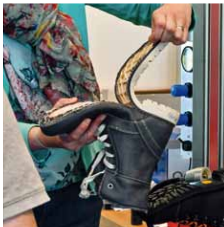
... und bei billiger Verarbeitung und schlechter Qualität sieht der Schuh dann so aus. In diesem Falle war die Sohle nur am Rand mit sehr wenig Kleber versehen. Der Test simuliert das Hängenbleiben mit der Sohlenspitze an einer Bordsteinkante
